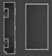
Kiriş ve Cam Kayıt Profilleri 30mm x 135mm 1.745gr/m 60mm x 120mm 1.900gr/m
